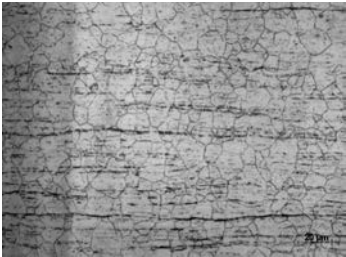
FIGURA 7. Micrografia utilizando solução de HNO3, ampliação de 1000X Fonte: Imagem do autor.
