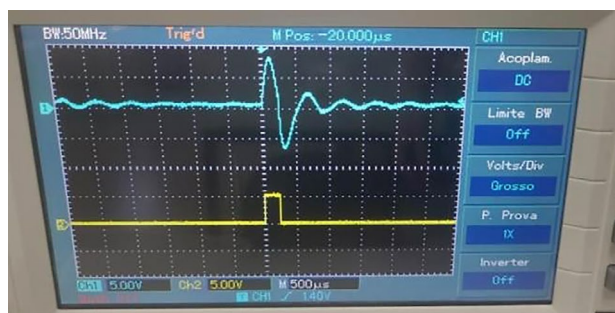
Figura 5 – Sinal do RLC ajustado (azul), PWM aplicado(amarelo)
