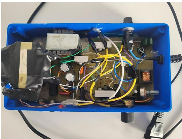
Figura 9 – Visão interna do circuito eletrônico desenvolvido no segundo protótipo
